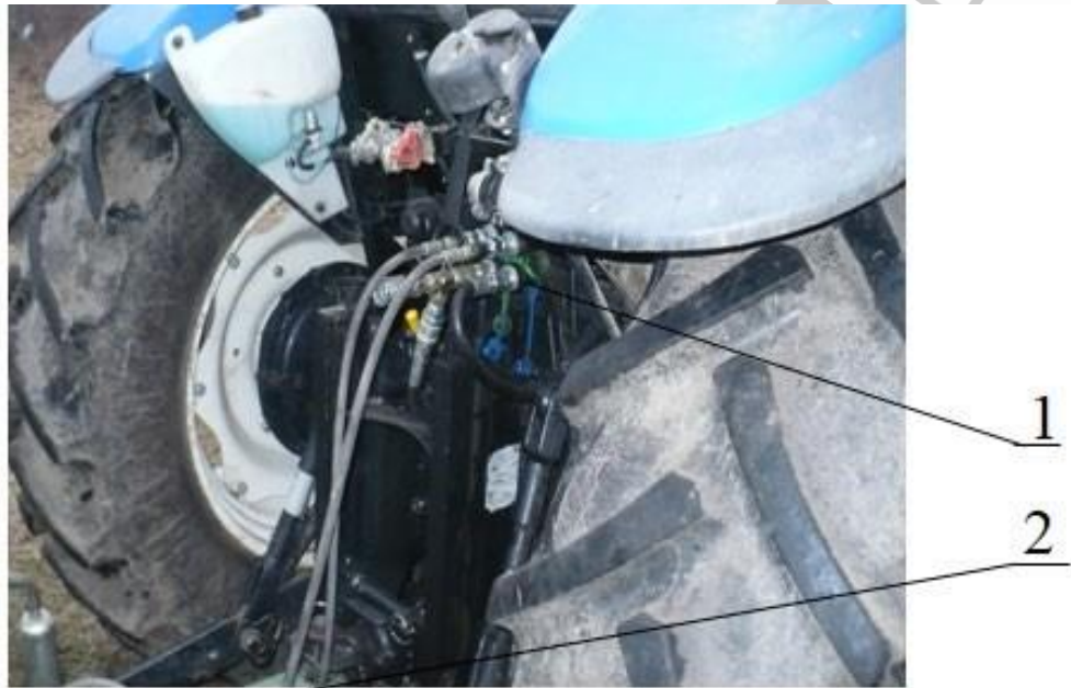
10 pav. Vyniotuvo prikabinimas prie traktoriaus: 1 - Hidraulinės žarnos; 2 - Prikabinimo kaištis.
