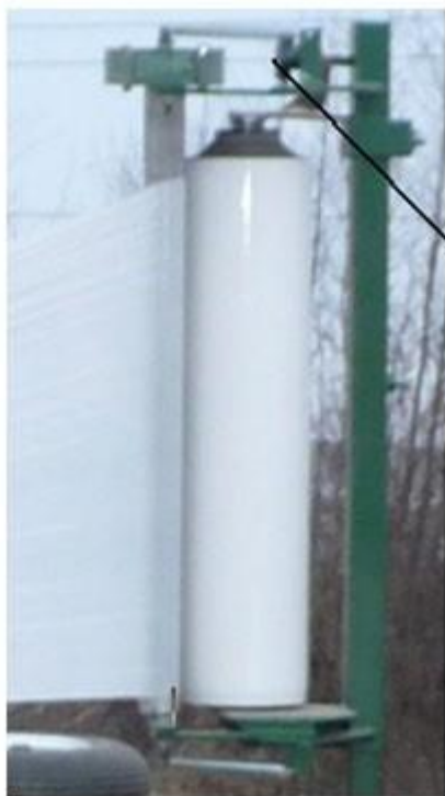
11 pav. Plėvelės ritinio įdėjimas į tiekimo įrenginį: 1 - Plėvelės ritinys; 2 - Ritinėliai iš aliuminio; 3 - Plėvelės ritinio prispaudimo veržlė.
