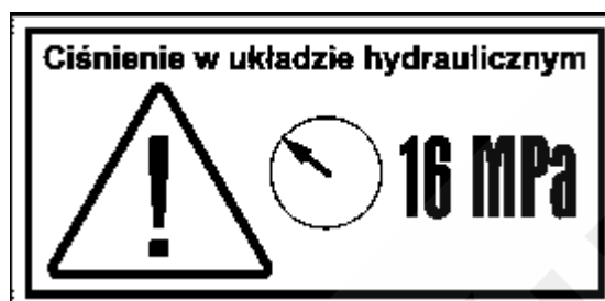
Rys 3 Ciśnienie znamionowe w układzie hydraulicznym.
