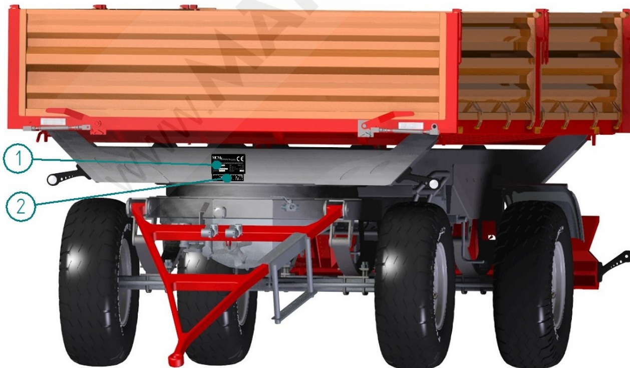
Rys. 1.1. Umieszczenie tabliczki znamionowej i numeru identyfikacyjnego. 1- tabliczka identyfikacyjna; 2- numer identyfikacyjny
