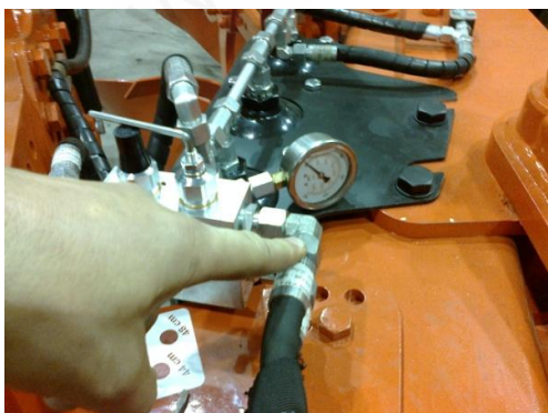
Podać ciśnienie na górny przewód – ciśnienie w układzie spadnie do zera.
