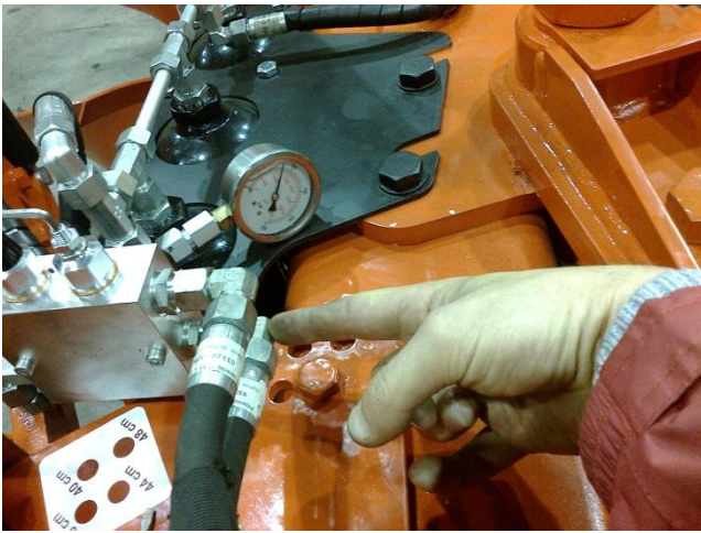
Rys.14. Regulacja czułości układu zabezpieczającego.
