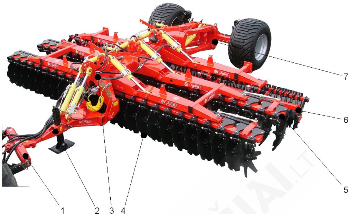
Pav. 3. Agregatas TIGER XL. 1- prikabinimo sija, 2- tempimo sija, 3- pagrindinis rėmas, 4- priekinė lėkščių sekcija, 5- galinė lėkščių sekcija, 6- volas, 7- važiuoklės mechanizmas.
