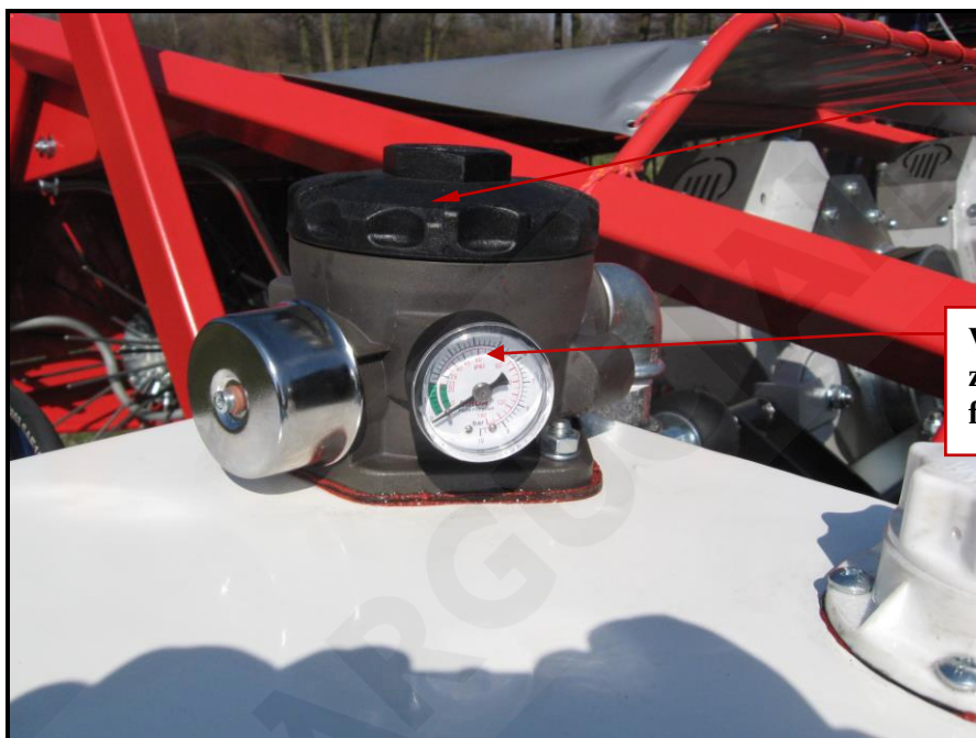
Fot. 43. Filtr powrotny oleju ze wskaźnikiem drożności filtra.
