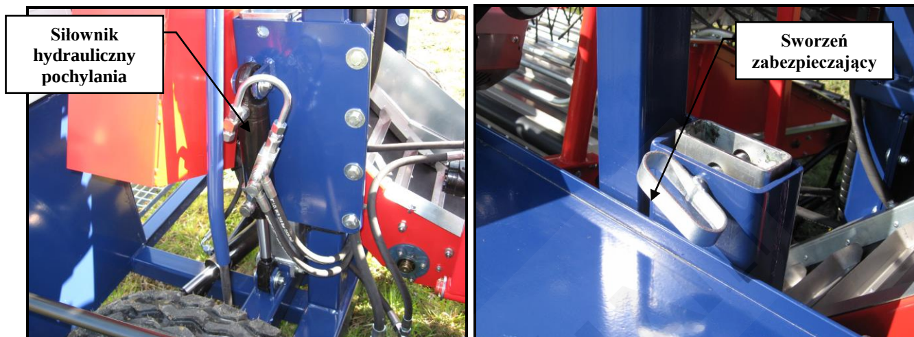
Foto 19a. Kombajn w wersji z pochylaną hydraulicznie ramą nośną
