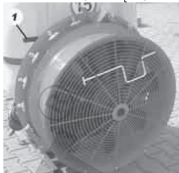
Rys. 7. Położenie dźwigni załączającej napęd wentylatora: 1 – dźwignia załączająca napęd wentylatora
