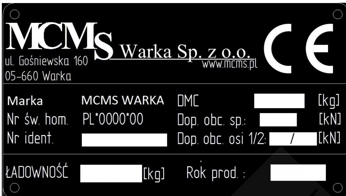
Rys. 1.2. Wzór tabliczki znamionowej.
