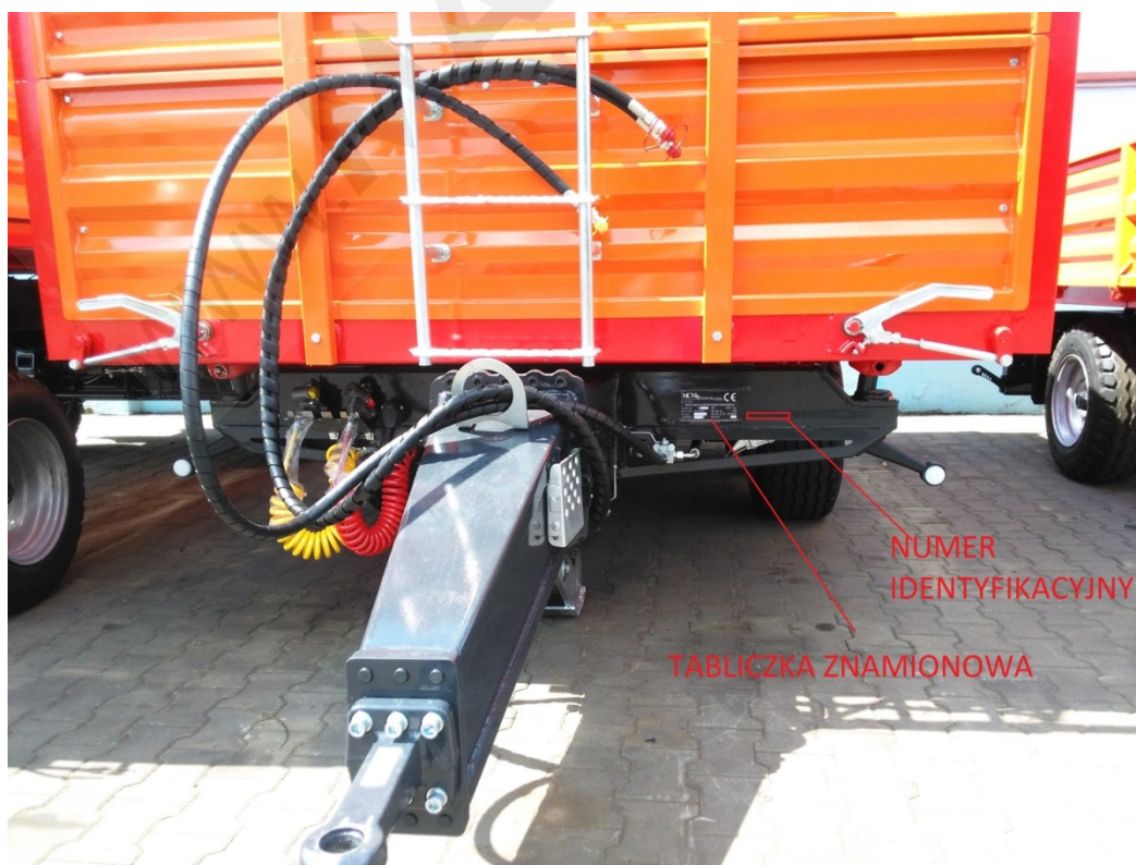
Rys. 1.1. Umieszczenie tabliczki znamionowej i numeru identyfikacyjnego.
