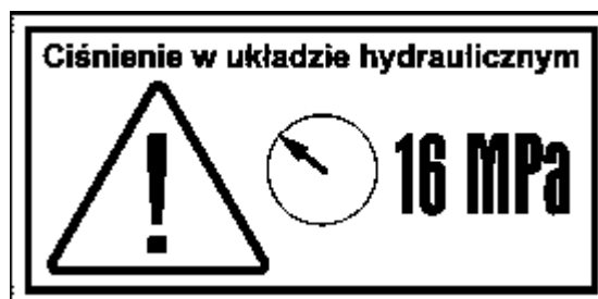
Rys 5 Ciśnienie znamionowe w układzie hydraulicznym.
