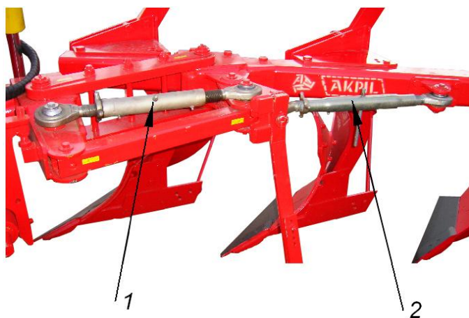
Rys.3. Śruby regulacyjne pługów serii KM80.
