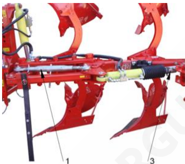
Rys.4. Śruba regulacyjna kąta belki pługów wyposażonych w cylinder do „prostowania” serii KM180.
