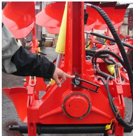
Rys.9. Zatrzaszek umożliwiający transport na kole.
