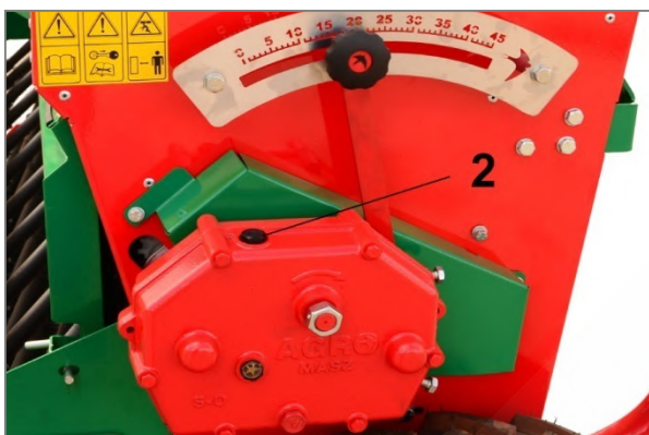
Bepakopės pavarų dėžės alyvos užpylimo taškas.
